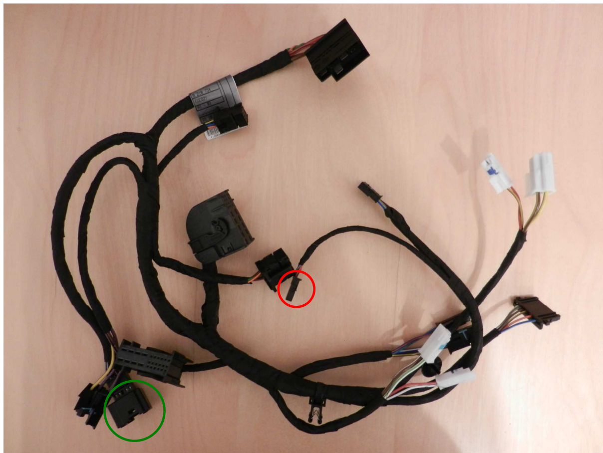
Abbildung 4: Ersatzteilkabelsatz Fahrerseite (für Modelle ab März 2010). Der Stecker für die Anbindung des Lordosenstützenschalters (roter Kreis) fehlte an dem original verbauten Kabelsatz. Der Stecker (grüner Kreis) wird nach dem Einbau mit der Adapterleitung verbunden.
