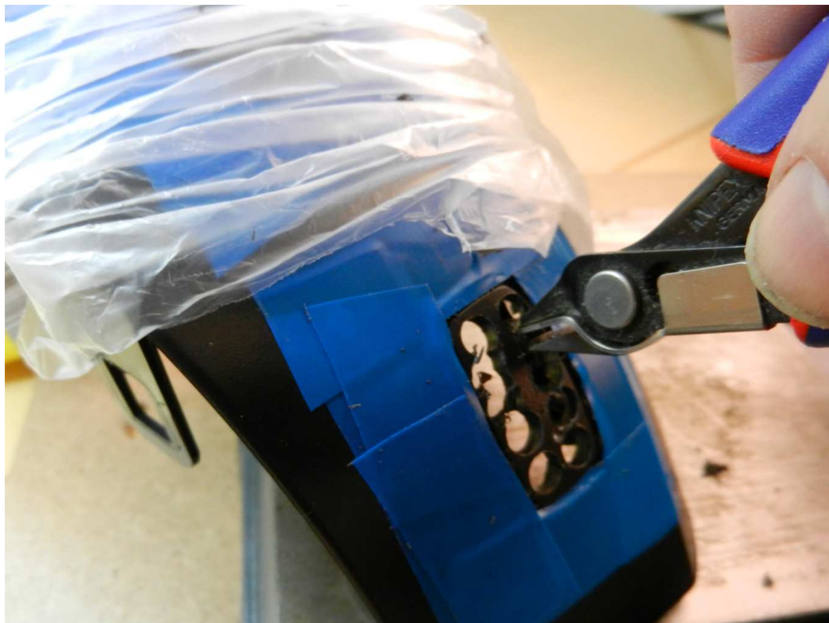
Abbildung 11: Die verbliebenen Stege zwischen den Löchern habe ich mit einem kleinen Seitenschneider durchgeknipst.
