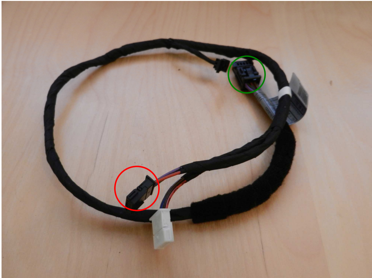
Abbildung 6: Ersatzteiladapterleitung Lordose Links Fahrerseite. Der schwarze Stecker für die Anbindung des Lordosenstützen - Ventilblocks (roter Kreis) fehlte an der original verbauten Adapterleitung. Der weiße Stecker ist für den Ventilblock der Lehnenbreitenverstellung. Der Stecker (grüner Kreis) wird nach dem Einbau mit dem „Kabelsatz Fahrerseite“ verbunden.
