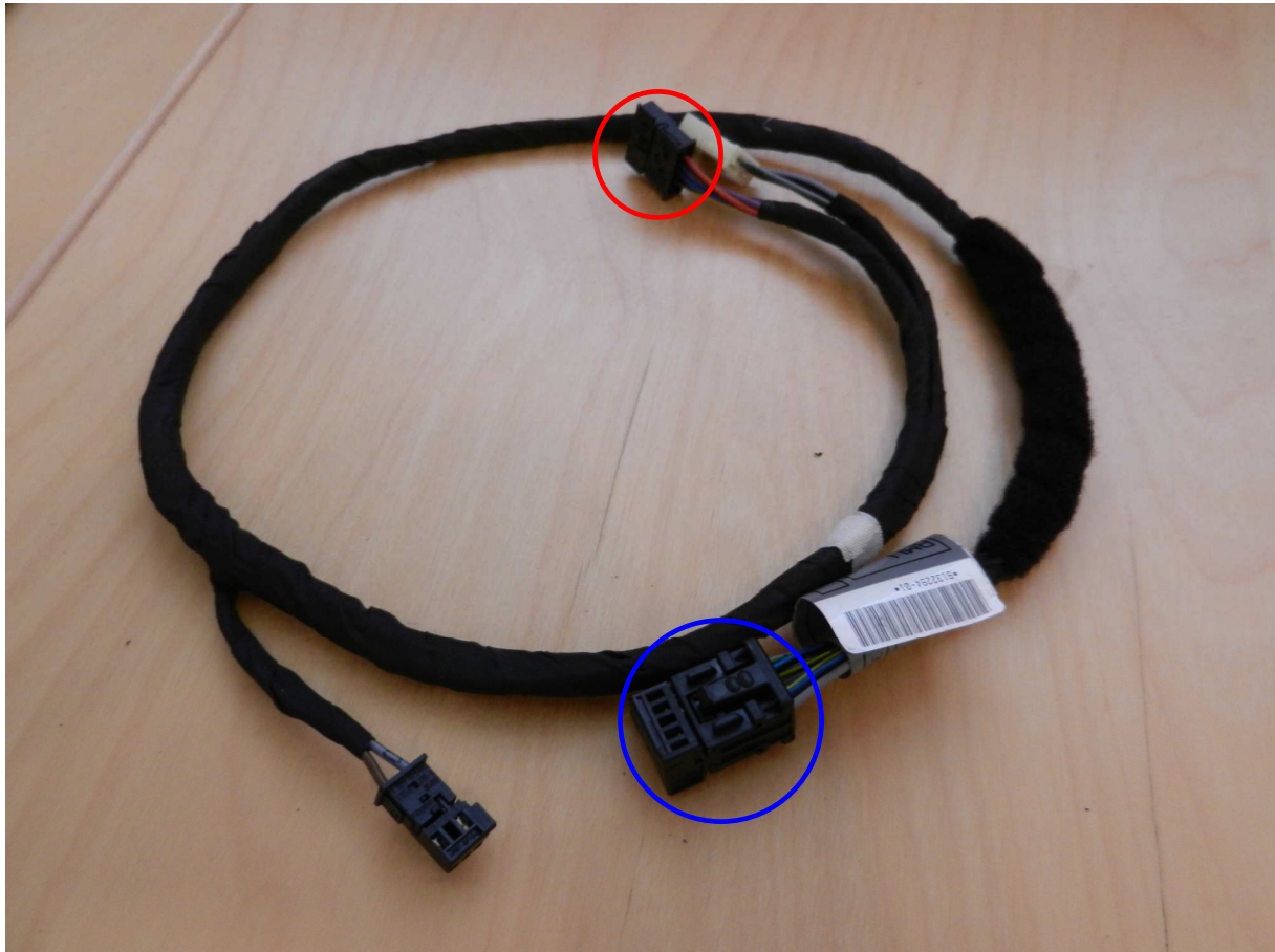
Abbildung 3: Ersatzteiladapterleitung Lordose Rechts Beifahrerseite. Der schwarze Stecker für die Anbindung des Lordosstützen - Ventilblocks (roter Kreis) fehlte an der original verbauten Adapterleitung. Der weiße Stecker ist für den Ventilblock der Lehnenbreitenverstellung. Der Stecker (blauer Kreis) wird nach dem Einbau mit dem „Kabelsatz Beifahrerseite“ verbunden.
